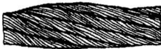
Рисунок 13. Местное увеличение диаметра каната.
