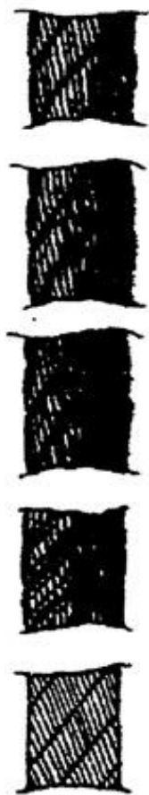
Рисунок 5. Износ наружных проволок каната крестовой свивки: а - небольшие лыски на проволоках; б - увеличенная длина лысок на отдельных проволоках; в - удлинение лысок в отдельных проволоках при заметном уменьшении диаметра проволок; г - лыски на всех проволоках, уменьшение диаметра каната; д - интенсивный износ всех наружных проволок каната (уменьшение диаметра проволок на 40 процентов).
