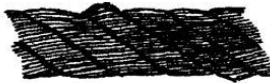
Рисунок 1. Обрывы и смещения проволок каната крестовой свивки.
