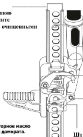
Рисунок 9. Места смазки домкрата.
